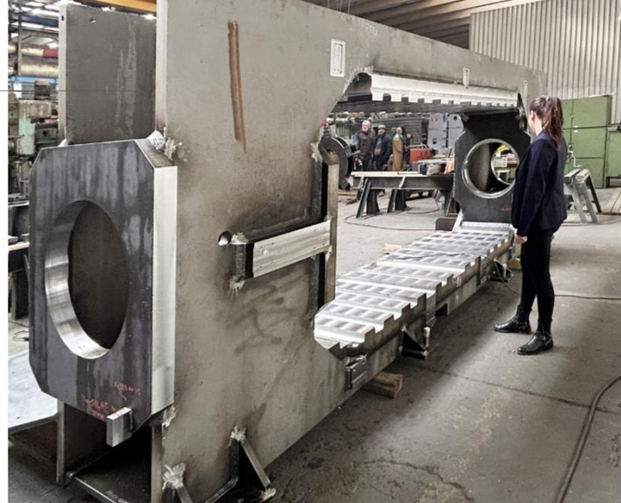
Schwerlastgerüst für Bahntechnik: Rund 20 Tonnen wiegt allein dieses Gerüst für den maschinellen Wechsel von Zugrädern. Hier geschweißt im Rohzustand ...
